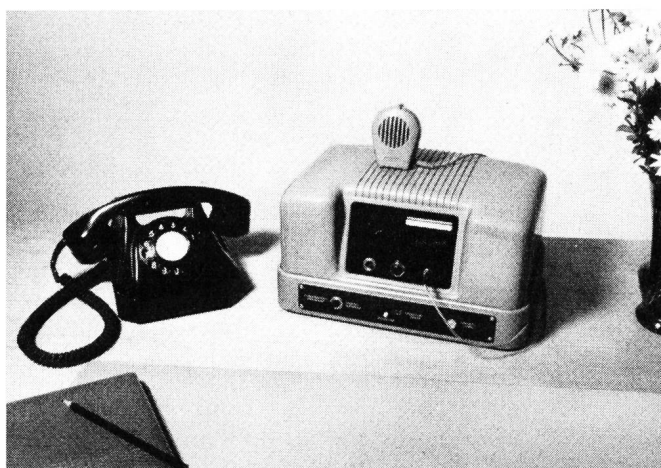
Fig. 5. Zusatzgerät zum Telephon für die Entgegennahme von Meldungen bzw. für das Erteilen von Auskünften bei Abwesenheit des Abonnenten
