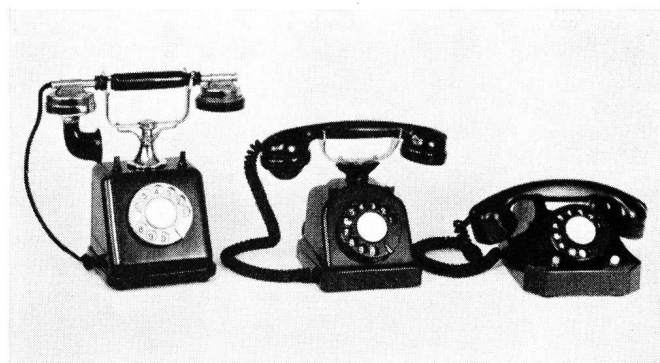
Fig. 2. Zur Entwicklung der Telephonstation in der Schweiz Links: Altes Modell zu Beginn der Automatisierung in den zwanziger Jahren; Mitte: Modell 29; Rechts: Moderne Ausführung Modell 50
