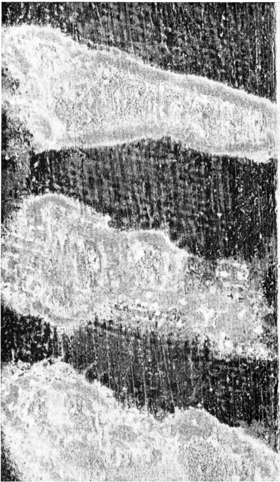
Fig. 10. Mit Baumwollband umwickelte, in destilliertem Wasser korrodierte Bleiplatte. Vergrößerung 1:3,7
