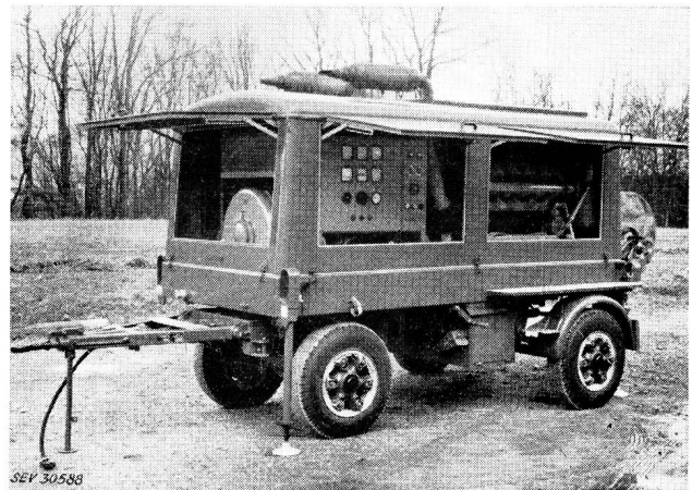
Fig. 20. Fahrbare Notstromanlage auf Zweiachsanhänger. Leistung 125 kVA, 220/380 V, 50 Hz, mit Antrieb durch Benzinmotor Installation de secours montée sur remorque à deux essieux. Puissance 125 kVA, 220/380 V, 50 Hz; entraînement par moteur Diesel
