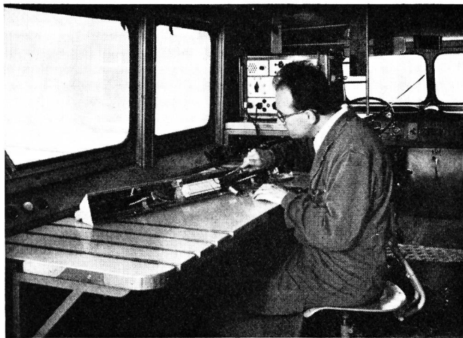
Fig. 2. Entstörungsarbeiten im Wagen des mobilen Dienstes Déparasitage dans une voiture du service mobile
