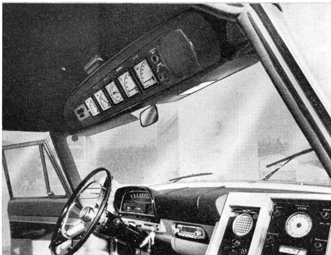
Fig. 5. Instrumenten-Paneel über der Windschutzscheibe Panneau des instruments en dessus du pare-brise
