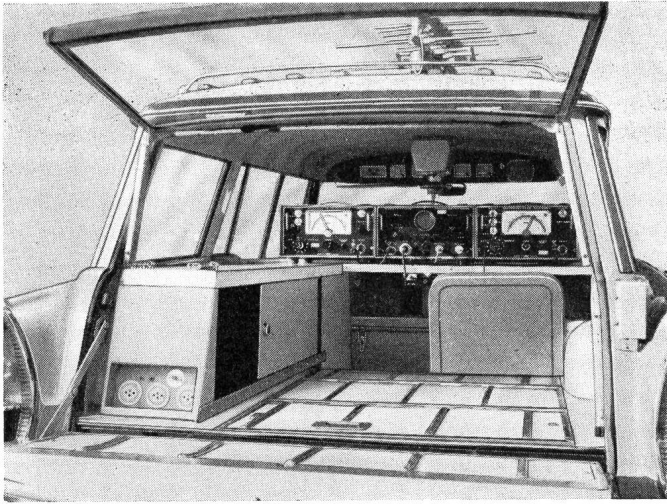
Fig. 2. Blick von hinten in den Wagen. Unter dem Quertisch ist neben dem Sitz der Batteriekasten sichtbar, der jedoch über die ganze Wagenbreite verläuft
