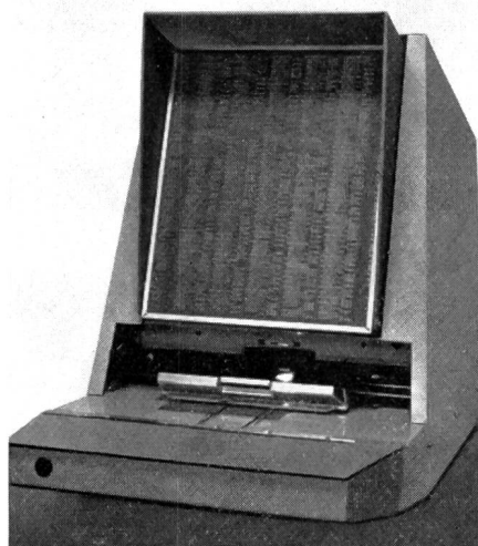
Fig. 8 Mikroplanfilm-Lesegerät von Alos
