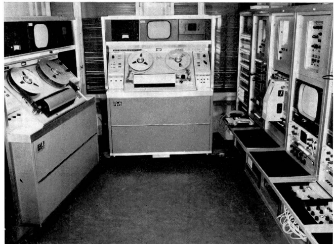
Fig. 5 Blick in den Apparateraum mit zwei Magnetaufzeichnungsanlagen, Bildendkontrolle und Dia-Abtaster. Auf dem Bilde nicht sichtbar: Ein 16-mm-Filmabtaster Vidikon und eine Perfomaschine 16 mm, verkoppelt mit Selsyn. Platzreserve für zweiten Abtaster ist vorhanden
