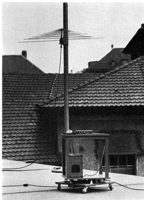
Fig. 4b Messapparatur zur Prüfung der Gehäuseabstrahlung Dispositif de mesure du rayonnement émis par le châssis
