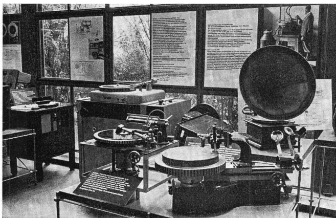
Fig. 4 Schallspeicherungstechnik im Rundfunk: rechts ein mechanischer Plattenspieler, davor eine Wachsplatten-Aufnahmeschneidmaschine (Modell R 20), links daneben ein Schallfolien-Aufnahmegerät R 21, dahinter das Universal-Abspielgerät R 32, links das erste Studio-Magnetbandgerät mit Gleichstrom-Vormagnetisierung (1938)
