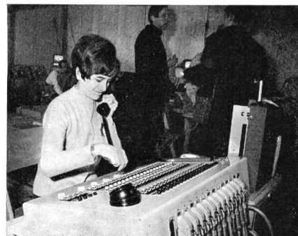
Fig. 2 Fernsehübermittlungszentrum. Bedienungspult für internationale Studio- und Reportageleitungen
