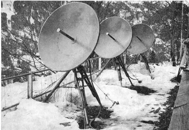
Fig. 8 Parabolantennen der mobilen Richtstrahlanlage Wengen-Jungfrauoch
