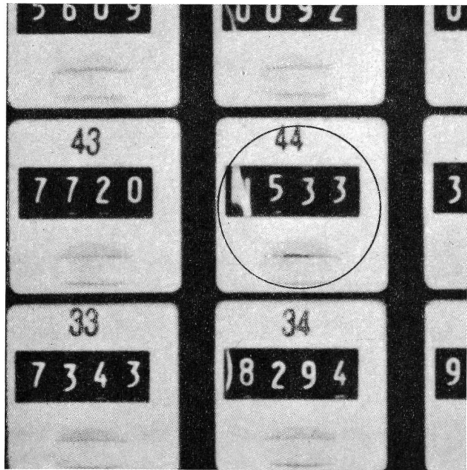
Fig. 4 Undeutlicher Zählerstand als Fehlerquelle
