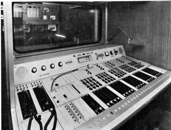
Fig. 12 Tonmischpult im Tonregieraum mit Durchblick durch die Trennwand aus Glas in den Bildregieraum. Der linke Pultteil ist mit den Verständigungs-Einrichtungen belegt (Telephon, Gegensprechen). Rechts unter der Lampe erkennt man das verschiebbare Manuskriptpult aus Plexiglas Pupitre de mélange de la régie du son avec vue vers la régie de l'image à travers la vitre de séparation. La partie gauche du pupitre est occupée par les appareils de communication (téléphone, interphone). Sous la lampe, à droite, on voit le pupitre mobile en plexiglas pour manuscrits
