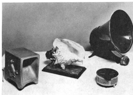
Fig. 2 Technik im Wandel: links Lautsprecherformen aus der Frühzeit, rechts Kopfhörer mit eingebautem Stereo-UKW-Empfänger (1969)
