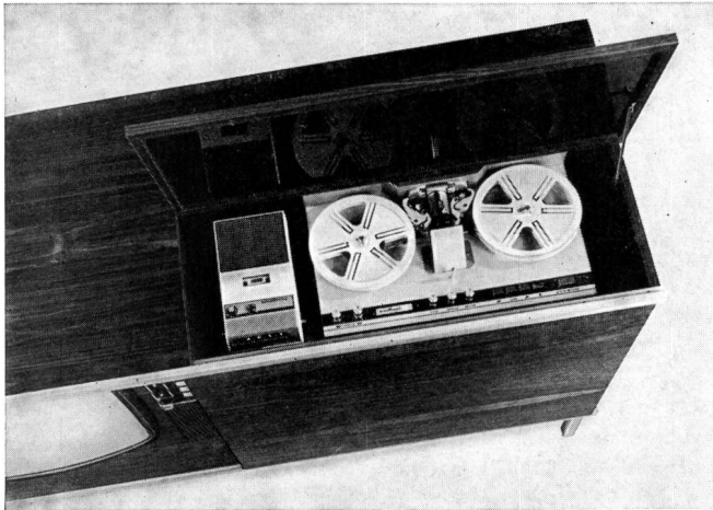
Fig. 4 Super-8-Filmabtaster für offene Spulen bis zu 18 cm Durchmesser, kombiniert mit einem Farbfernsehgerät (Nordmende)
