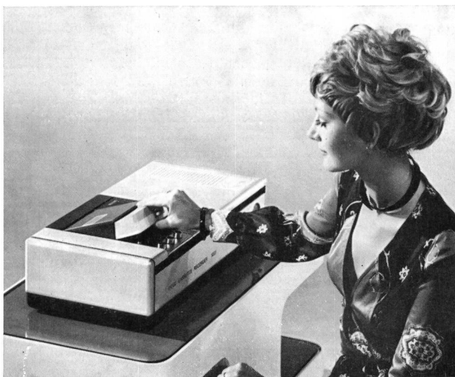
Fig. 3 Enregistreur vidéo à cassettes avec prise d'antenne et tuner incorporé
