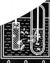
Netrum-Schwefel-Zelle der Firma Ford. Die H_2 (links) wandern durch die Keramik. Die Elektronen ( ) wandern über die negative
