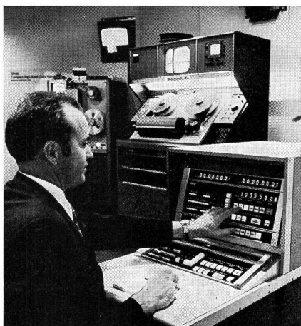
Fig. 2 Unité programmable pour le montage de bandes magnétiques
