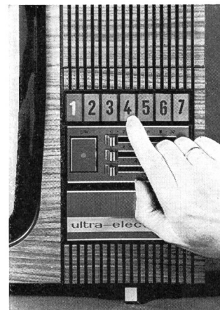
Fig. 15 Programmtasten (7), die über Berührungsfelder – und mit der in Figur 14 gezeigten Programmwahlautomatik – selbsttätig die genaue Einstellung des gewünschten Senders vornehmen
