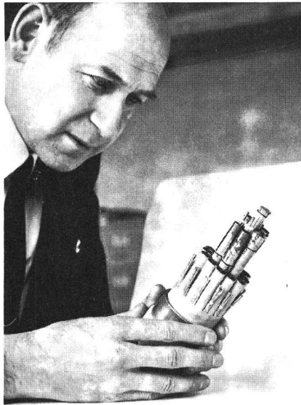
Fig. 1 Das neue 18-tubige Koaxialkabel der Britischen PTT für deren Versuche mit dem 60-MHz-System. Das Kabel mit Stahlseilseele ist durch einen Metallmantel geschützt. Zwei der Innentuben dienen als Reserve
