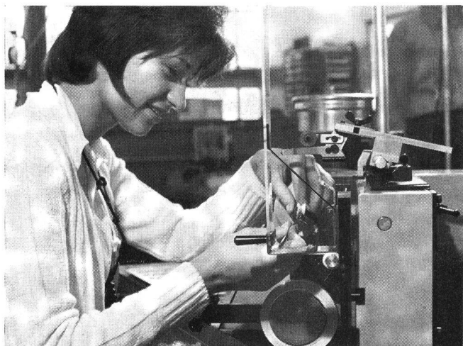
Fig. 1 Für diese Arbeit – Spulnwicklerei – eignen sich Frauenhände ganz besonders, denn der Draht ist ganze 0,07 mm dick. Die Maschine selbst überwacht die exakte Anzahl der Wicklungen
