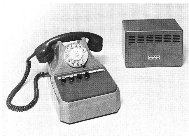
Fig. 1 Telephonstation für Sprachübertragung auf Datenmietleitungen, mit Netzgerät – Poste téléphonique pour les transmissions vocales sur les circuits loués de données, avec le bloc d'alimentation correspondant
