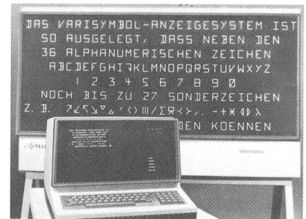
Fig. 15 Varisymbol-Anzeigetafel mit Datensichtgerät für die Eingabe (Fotos und Zeichnungen: AEG-Telefunken)
