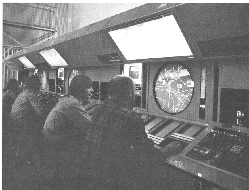
Fig. 1 Darstellung extrahierter Radarbilder (DERD) mit Computerhilfe
