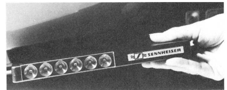
Fig. 10 Sechs Infrarotdioden, als «Tonsender», eingebaut in der Front eines Fernsehgerätes, ermöglichen den drahtlosen Kopfhörerempfang im ganzen Raum (Foto Sennheiser)
