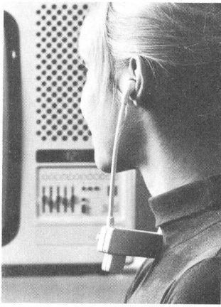
Fig. 12 Infrarot-Ohrhörer mit in den Bügel eingebautem Empfänger und Stromversorgung (unten links) (Foto Metz)
