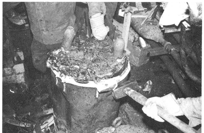
Fig. 6 Entfernen der Deckelrandüberreste – Destruction à la masse du reste du bord
