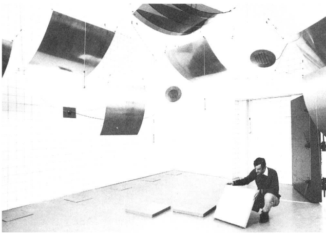
Fig. 7 Chambre réverbérante de la Division des Recherches et du Développement de l'Entreprise des PTT suisses, permettant la mesure du coefficient d'absorption des matériaux acoustiques selon la recommandation R 354 de l'ISO
