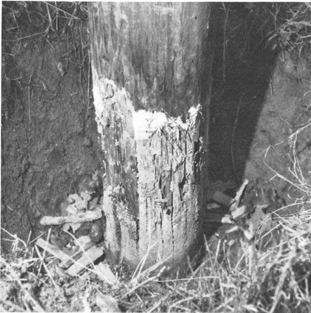
Fig. 7 Teilweise vom Pilz zerstörter Mast im Stangengarten
