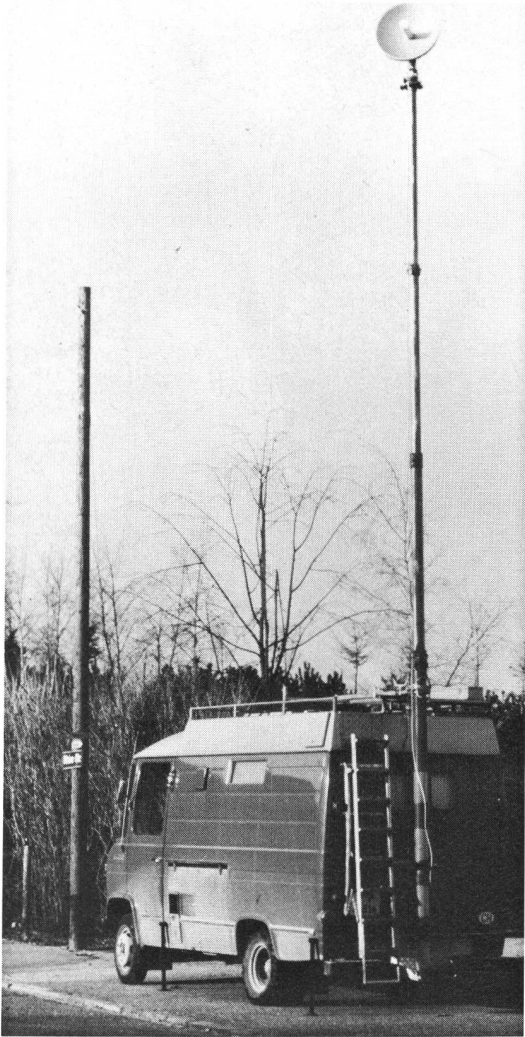
Fig. 7 Voiture de mesure équipée du convertisseur SHF-UHF
