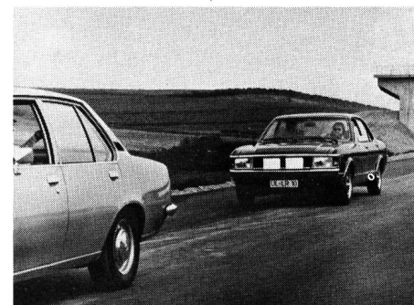
Fig. 3 Zur Abstandsmessung und Hinderniswarnung im Strassenverkehr entwickelte AEG-Telefunken gemeinsam mit der Robert Bosch GmbH ein hochauflösendes 35-GHz-Impulsdopplerradar. Dieses warnt besonders im Schnellverkehr, wenn voranfahrende Fahrzeuge durch plötzliches Vermindern ihrer Geschwindigkeit die Gefahr des Auffahrens heraufbeschwören. Typisch sind die Sende- und Empfangsantennen vor dem Kühler
