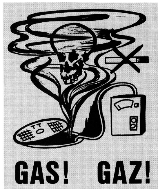
Fig. 13 Gaswarnaffiche (in auffällig roter Grundfarbe). Sie wird in Personal-Aufenthaltsräumen und an der Tür von gasgefährdeten Räumen befestigt - Panneau de mise en garde (fond rouge très voyant). Il est placardé dans les salles de séjour du personnel et à la porte de locaux où pourraient s'accumuler des gaz explosifs
