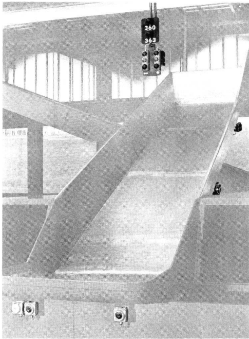
Fig. 57 Ausrüstung einer Arbeitsstelle mit Not-Aus-Taster, Aufforderungstaster und entsprechender Lampenkombination – Equipement d'une place de travail avec bouton de déclenchement de secours, bouton de demande d'extraction et combinaison de lampes correspondante
