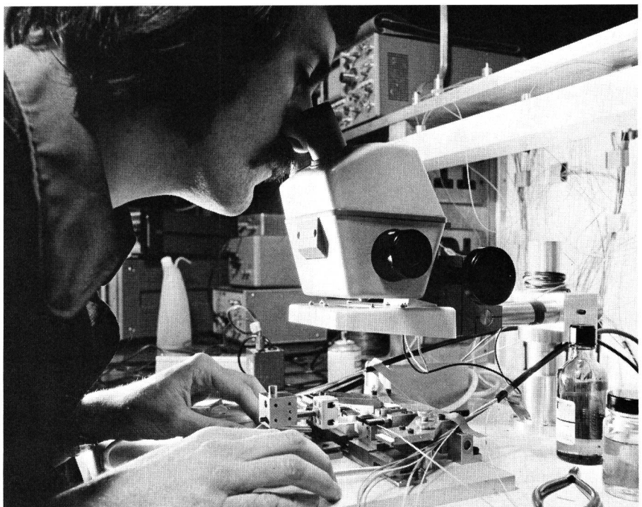
Fig. 1 Hier werden unter dem Mikroskop zwei Glasfasern von 100 Mikron Durchmesser aufeinander angepasst, um dann mit Hitze und Ultraviolett «verschmolzen» zu werden
