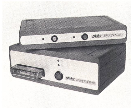
telesignal Kleine handliche Geräte zum Steuern, Melden, Überwachen oder Alarmieren über das öffentliche Telefonnetz
