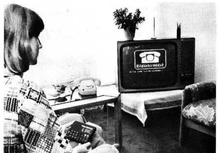
Fig. 16 Bildschirmtext im Zweiwegverfahren der Deutschen Bundespost, vorne das einfache Bediengerät (drahtlos) für die Kommunikation mit dem Computer (Foto DBP)
