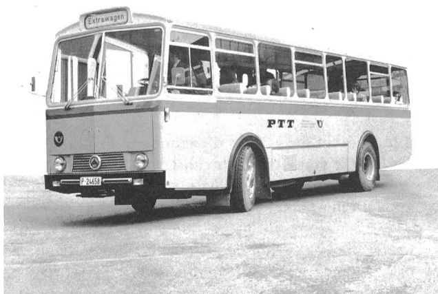
Fig. 2 Versuchsfahrzeug vom Typ Saurer 3 DUK 50L, ausgerüstet mit einem Motor von 158 kW (215 PS) Leistung bei 2200/min und einem maximalen Drehmoment von 765 Nm (78 mkp) bei 1400/min — Véhicule d'essai du type Saurer 3 DUK 50L, équipé d'un moteur développant 158 kW (215 CV) à 2200/mn et un couple maximal de 765 Nm (78 mkp) à 1400/mn
