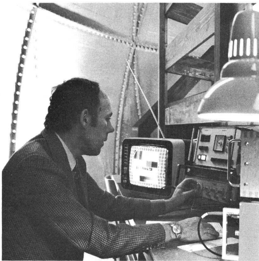
Fig. 1 Teilansicht des Messplatzes. Auf dem Fernsehbildschirm sind im Testbild deutliche Bildverzerrungen eines störenden Handsprechfunkgerätes zu erkennen
