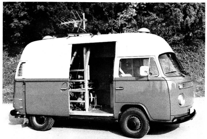
Fig. 7 VW-Grossraumkastenwagen für Empfangsuntersuchungen
