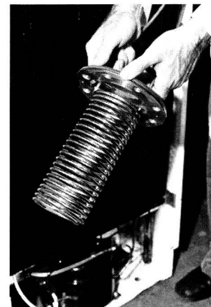
Heizflansch für den Gefrierschrank als Warmwasserbereiter, der in einem Wasserspeicher eingebaut wird
