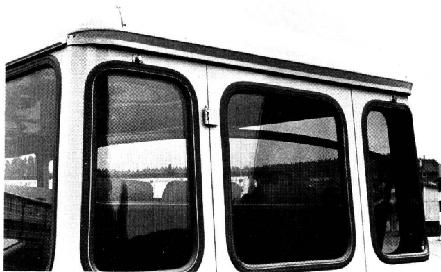
Fig. 5 In die Karosserie integrierter Dachspoiler zur Sauberhaltung der Heckscheiben
