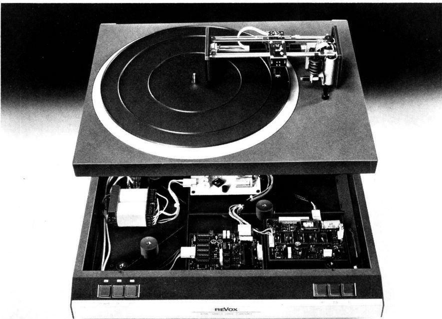
Fig. 3 Das Doppelchassis des Tangential-Plattenspielers B 795 mit festem und «schwimmendem» Teilchassis
