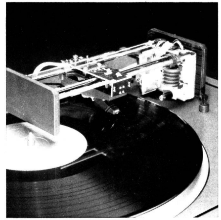
Fig. 4 Schwenkarm bei abgenommener Abdeckung. Sichtbar ist die Tonarmführung mit hochpräzisem Saitenzug und dem kurzarmigen (40 mm) Leicht-Tonabnehmersystem P 20 MDR
