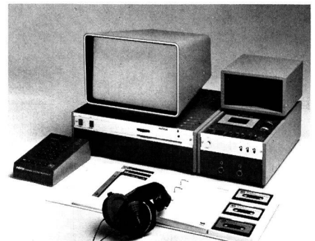
Fig. 5 Arbeitsplatz des Revox-Audiocardsystems, bestehend aus Mikrofilmgerät, Kassettengerät und Lautsprecher sowie (vorne links) aus mikroprozessorbestückter Tastatur für die Anwahl beliebiger Bilder aus dem Mikrofiche und der zugehörigen Tonsequenz
