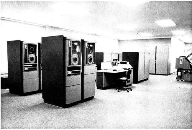
Fig. 1 Zentraleinheit U-3760 mit Systemkonsole und den kombinierten Magnetband- und Plattenspeicherstationen. Im Hintergrund die Scanner und der Klimaschrank — Unité centrale U-3760 avec console et les unités de bandes magnétiques et disques combinés. A l'arrière-plan, les équipements de lecture (scanner) et l'armoire contenant les équipements de climatisation
