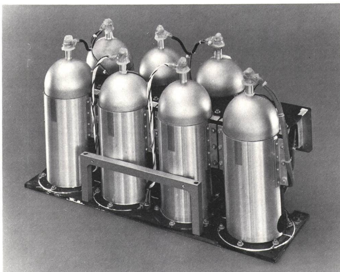
Fig. 13 Nickel/Wasserstoff-Akkumulatorenatterie, wie bei einem Versuchssatelliten eingesetzt — Batterie d'accumulateurs nickel/hydrogène, telle qu'elle est utilisée dans un satellite d'essai
