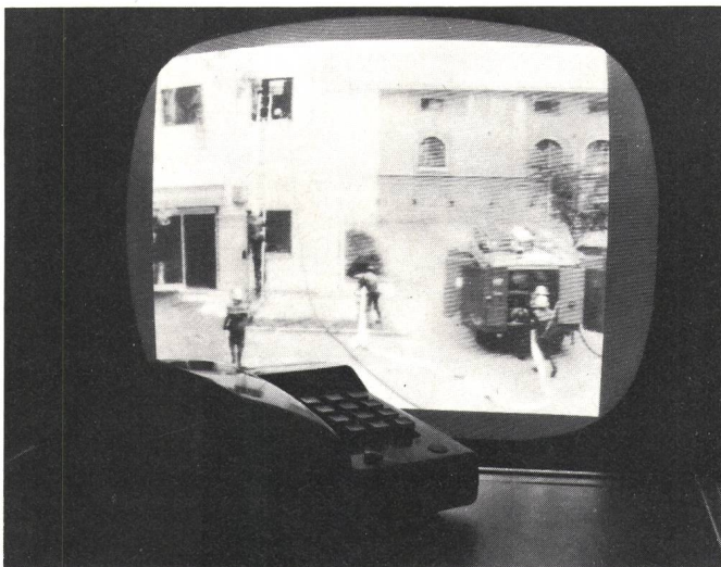
Fig. 2 Bewegtbildübertragung mit reduzierter Auflösung über normale Telefonleitung mit 9,6 kbit/s
