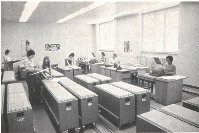
Fig. 5 Mutieren der Telefonbucheinträge im ehemaligen Flexoprintbetrieb. Zehnmal so viele Planetenbehälter wie auf dem Bild sichtbar waren nötig, um die Einträge aller 18 Telefonbücher zu speichern — Mutation des indications destinées aux annuaires téléphoniques avec l'ancien système Flexoprint. Pour mémoriser les indications des 18 annuaires téléphoniques, il fallait dix fois plus de conteneurs à plateaux que ceux qui apparaissent sur cette photo
