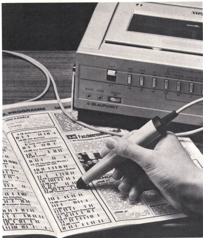
Fig. 1 Das von Blaupunkt entwickelte digitale Kennungssystem «ZPS» (Zusätzliche Programmdaten in Synchronpausen) macht es dem Benutzer möglich, mit Lichtgriffel und Strichcode aus einer Programmzeitschrift sein Wunschprogramm auszuwählen (Foto: Blaupunkt)
