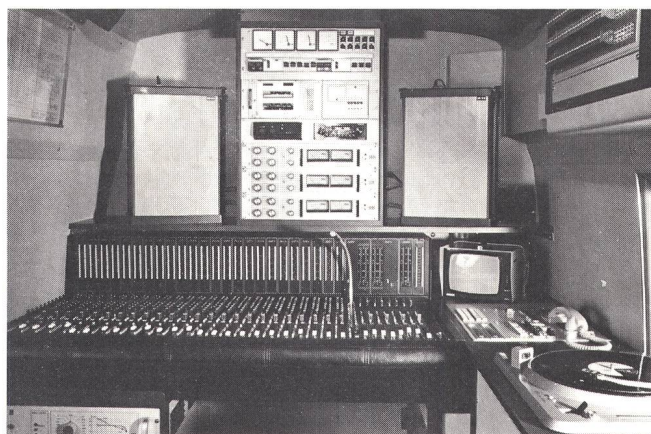
Fig. 7 Mischpult mit der aufgesetzten Matrix 24 \times 24 . Rechts und über dem Mischpult sind die Kontrollgeräte ersichtlich — Pupitre de mixage avec matrice 24 \times 24 mise en place. Les équipements de contrôle sont visibles à droite au-dessus du pupitre
