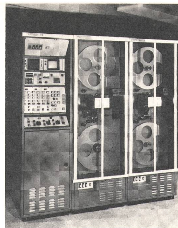
Fig. 13 Télécinéma à CCD équipé de deux projecteurs (système multiplexe) de Rank Cintel
