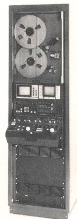
Fig. 10 Nouveau magnétoscope 1" montage baie, format B
