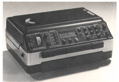
Fig. 9 Magnétoscope portable 1" format B
