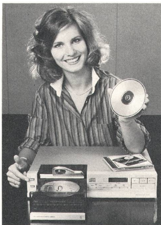
Fig. 6 Compact-Disc-Plattenspieler. Die verschleissfreie Platte ist nur 12 cm gross und hat eine Spielzeit von bis zu einer Stunde
