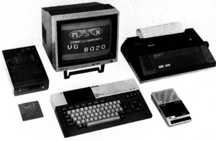
Der MSX-Homecomputer VG 8020 mit 80 Kbit Speicherkapazität umgeben von den von Anfang an verfügbaren Peripheriegeräten
