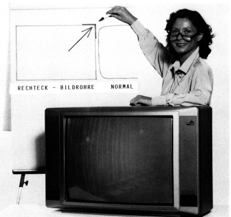
Fig. 1 Stereo-Zweikanalton-Fernsehempfänger mit der neuen flacheren und rechteckigeren Bildröhre
