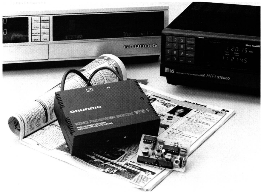
Fig. 2 Gewisse ältere Videorecorder lassen sich mit einem Adapter (Gehäuse vorne) oder mit einem steckbaren Coder nachträglich noch für das Video-Programmiersystem VPS ergänzen
