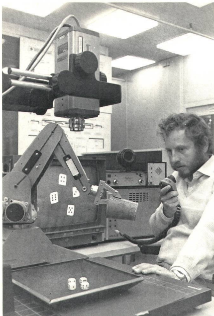
Fig. 5 Ein Robotersystem, das sieht, hört, spricht und handelt. Der Roboter würfelt, erkennt über die Kamera das Ergebnis und sagt dieses an. Auf einen gesprochenen Befehl hin ergreift er den Würfel mit der angesagten Augenzahl und legt ihn in den Becher zurück
