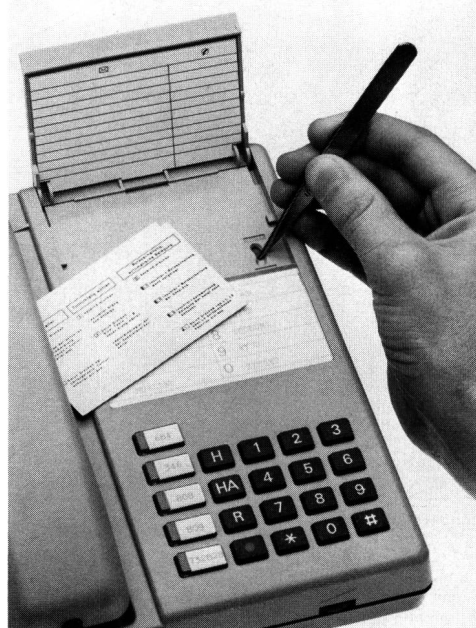
Fig. 5 Der neue LW-Apparat kann durch den Installateur einfach programmiert werden. Bei Änderungen der Konfiguration muss der Apparat im allgemeinen nicht geöffnet werden – Le nouvel appareil LW peut être programmé simplement par l'installateur. Il n'est en général pas nécessaire d'ouvrir l'appareil pour modifier la configuration de l'installation
